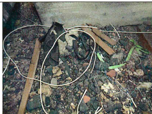
Bild 26. Interiör vind. Slaggsten som kan innehålla tungmetaller.
