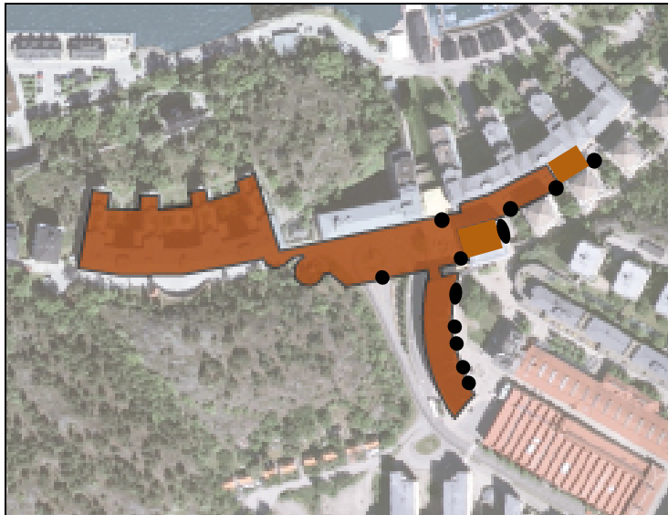
Torggaragets utbredning med befintliga schakt för brandgasventilation
