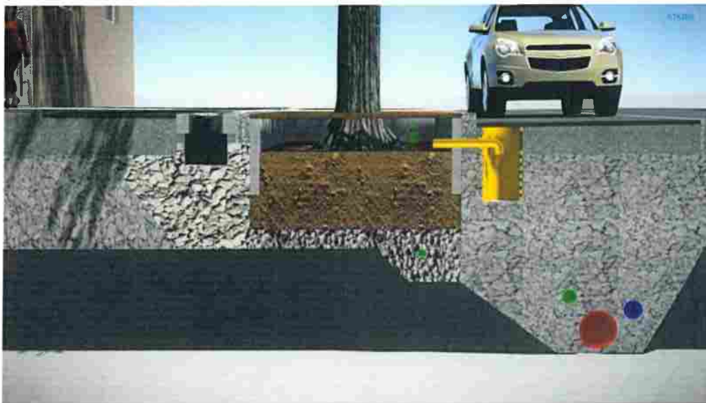
Figur 8. Täckt regnbädd i gata. Dagvatten från GC-bana leds in via luftningsbrunn med sandfång och perforerad sida till luftigt bärlager (t v i övre bilden) ner i skelettjorden som anläggs intill regnbädden. Dagvatten från väg leds via inloppsbrunn med sandfång (gul) till nedsänkt regnbädd som är täckt med markgaller eller plåt. Inloppsröret mynnar några centimeter över växtbädd. Överskottsvatten avleds via dränering och bräddbrunn.
