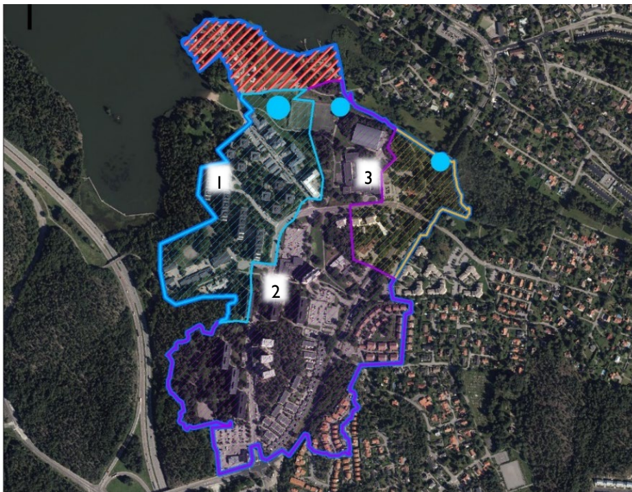
Figur 26. Bild visar tre delavrinningsområden inom detaljplaneprogramområdet. Blå punkter visar en ungefärlig placering av släpppunkt. I rödskratterat område längst norrut antas vattnet ledas direkt till Ältasjön. Bild: Sweco
