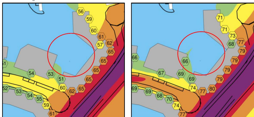
Trafikbullernivå vid planerad förskola Ältavägen/lokalgata.
