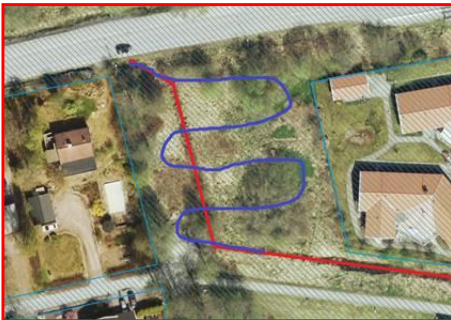
Figur 4.6. Skapande av meanderslingor på delsträcka i dikningsföretaget. Åtgärd för vattenkvalitet och biologisk mångfald. Överst visas vilken del av dikningsföretaget som berörs av åtgärden. Nederst en skiss på förslag till utformning av åtgärden (Nacka kommun).
