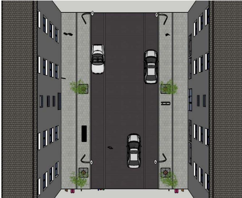
Bild: Lokalgata exempel 3. Bredd 18 meter med ett smalare mått på trottoar men med möbleringszon som ansluter till trottoar. Parkering på båda sidor och cykel i blandtrafik.
