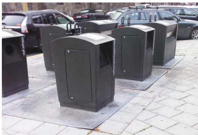
Referensbild, nedgrävda behållare för avfall
