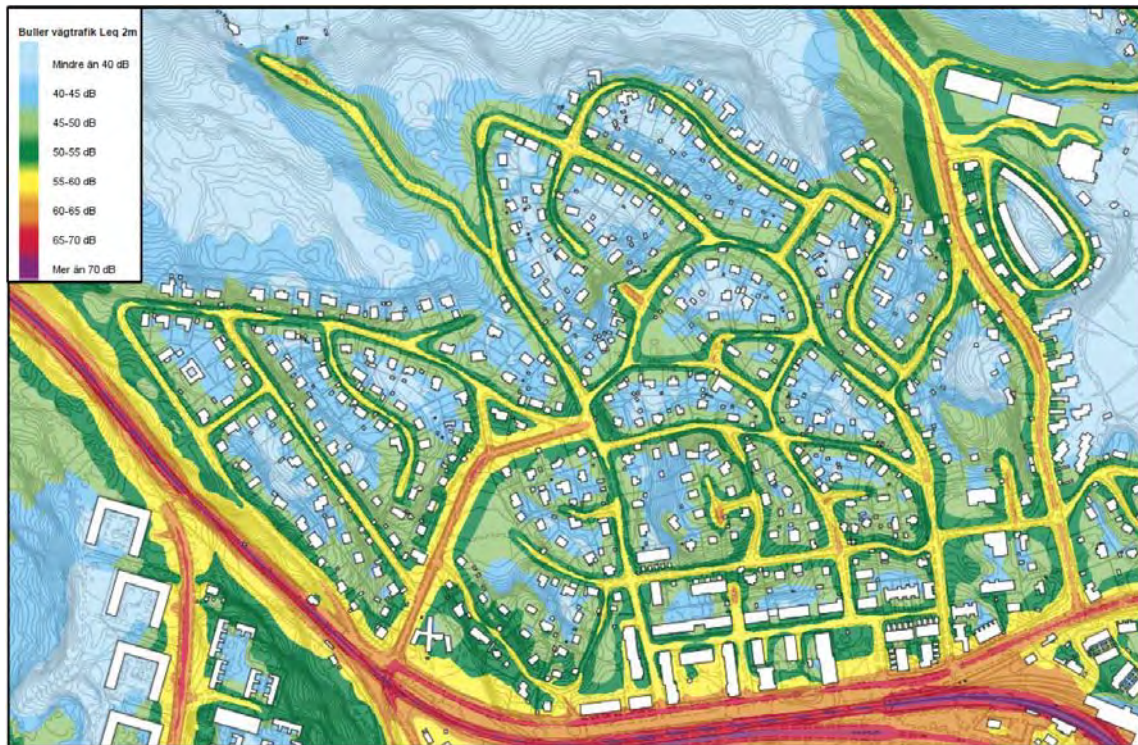
Ekvivalent ljudnivå, 2 meter över mark, från vägtrafik och Saltsjöbanan, dagens situation (år 2015).
