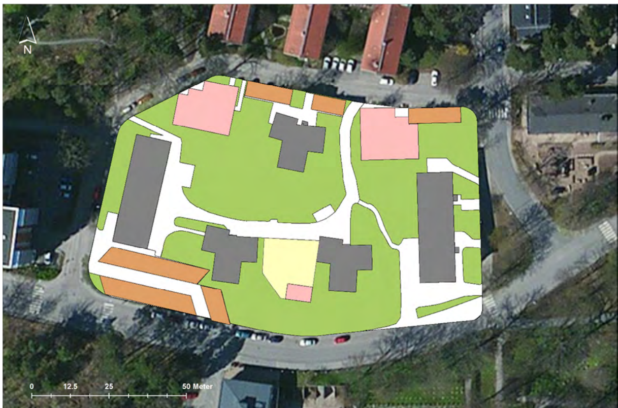
Figur 3-3. Planerad markanvändning inom fastigheten Sicklaön 125:3. Vit = Asfaltsyta, Orange = genomsläpplig asfalt, Grå = Befintlig takyta, Rosa = Planerad tillkommande takyta, Gul = Lekplats.
