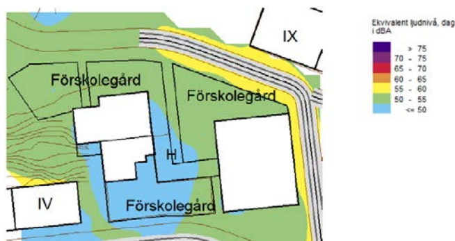
Ljudutbredning 1,2 m över mark vid förskolegård. Ingen genomfartsväg vid Svackan. Bild: Structor
