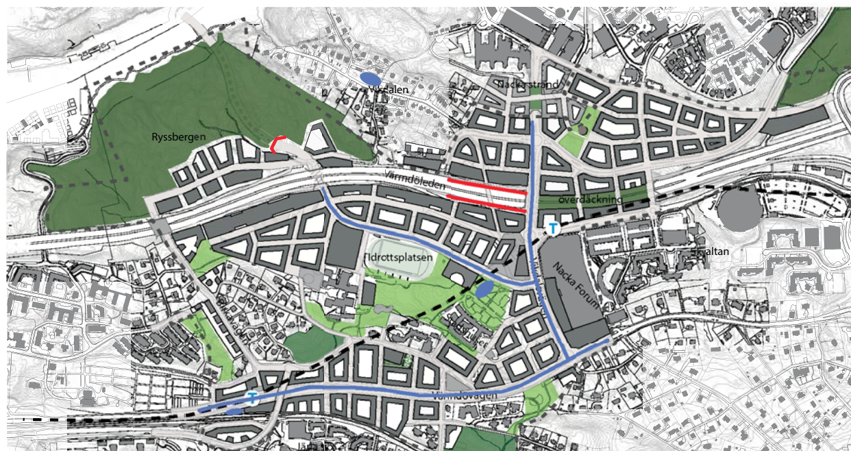
Blåa markeringar är förslag på fördröjnings-/reningsanläggning och utredningsområden för dagvatten, röd markering visar på kvarter som kan utsättas för höga halter av luftföroreningar med risk för överskridande av miljö kvalitetsnormer för PM10.
