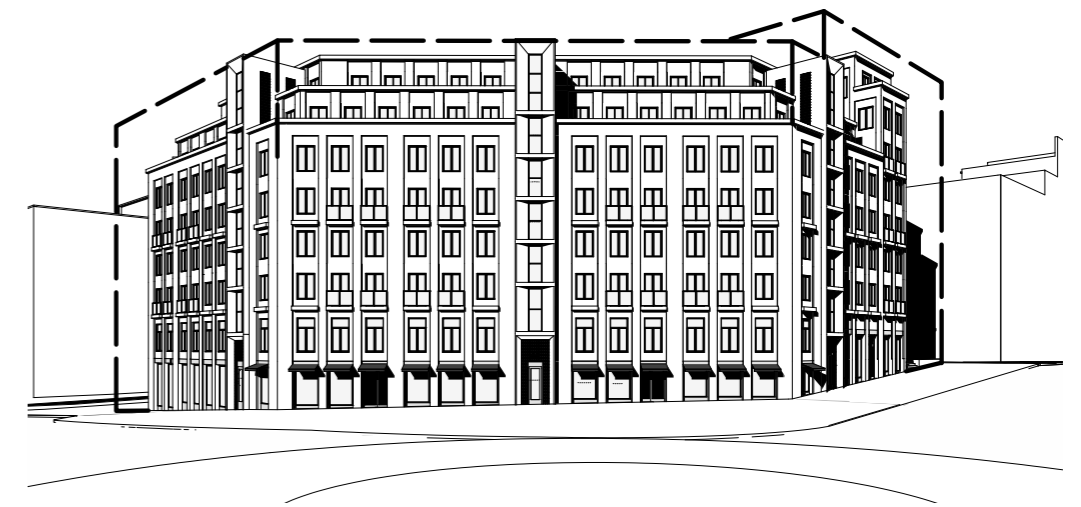
Avskurna hörn och terrassering ger byggnaden visuellt en nättare volym med ett bibehållet högt markutnyttjande.
