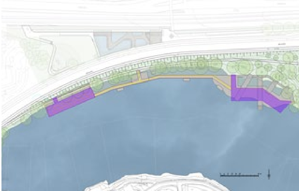
Figur 3 Lila markering – Ungefärlig utbredning av bryggdäcken för den anläggning ansökan om investeringsmedel avser. Utförande för vilket miljödome erhållits syns i botten av bilden.
