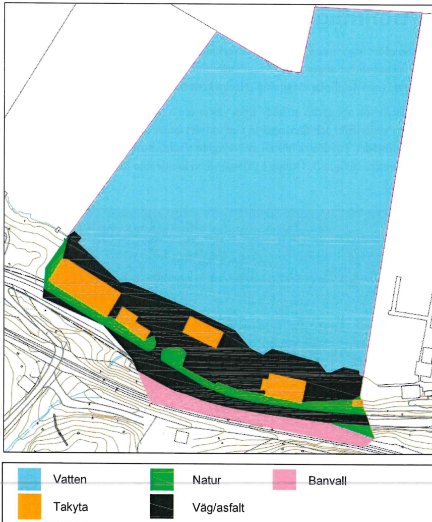
Figur 4. Typ av markbeläggning inom det befintliga avrinningsområdet
