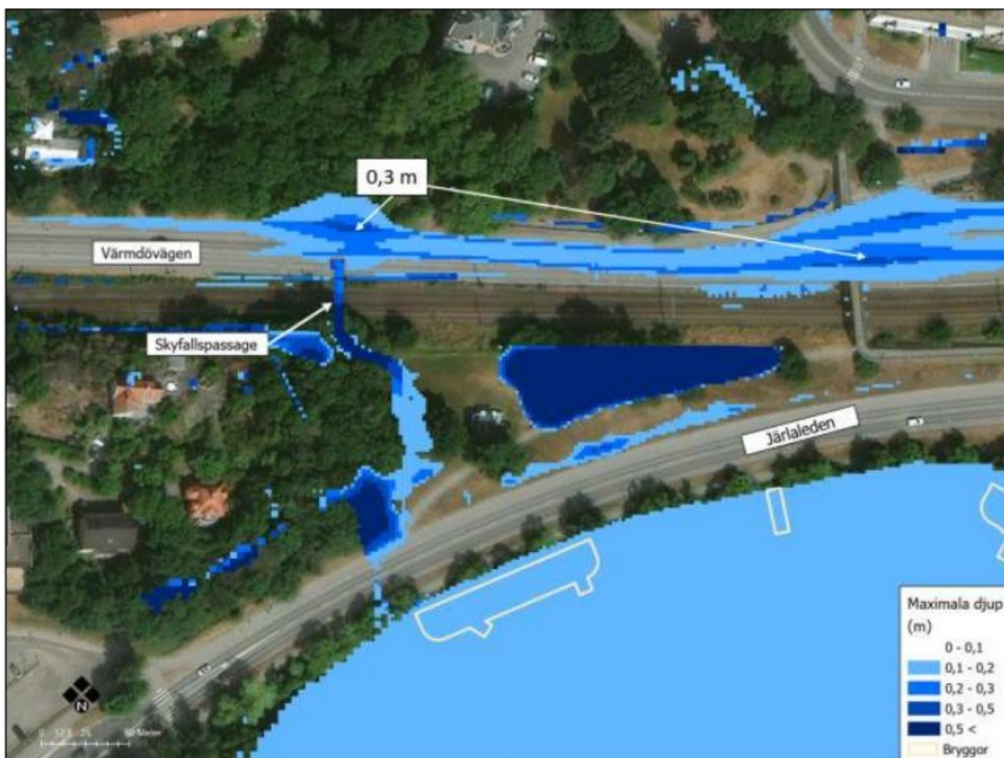
Figur 18. Beräknade maximala vattendjup vid planerad situation och föreslagen skyfallspassage, i samband med ett 100-årsregn inklusive klimatfaktor 1,25. Källa: Norconsult AB (2022).
