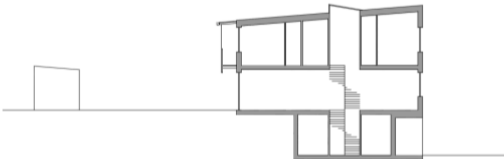
Sektionen visar hur radbusen tar upp befintliga höjdskillnader med ett souterrängplan (Berg/C.F. Möller Arkitekter).
