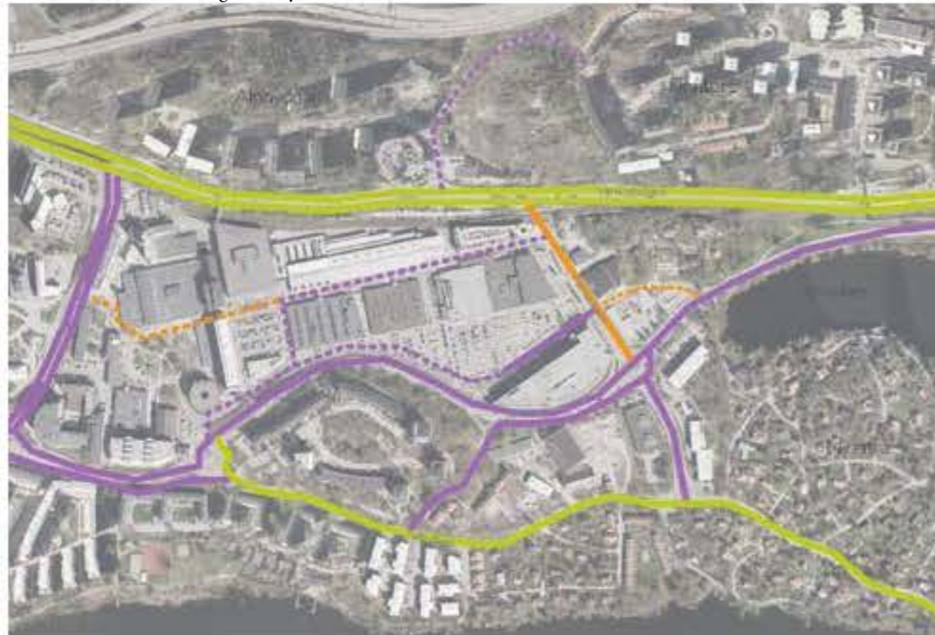
Bilden visar föreslaget cykelvägnät - orange illustrerar kompletteringar av dagens nät i lila. Streckad linje illustrerar cykel i blandtrafik. De regionala cykelstråken visas gröna och föreslås uppgraderas.
