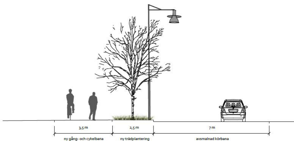
Principsektion ny utformning av Gamla Skärgårdsvägen Skala 1:100
