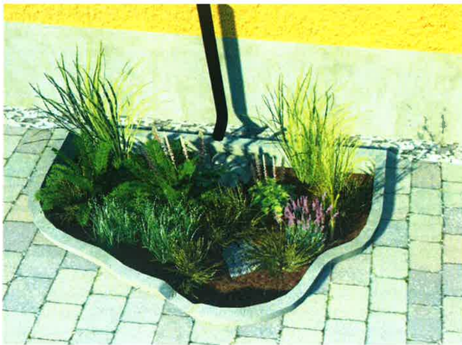
Figur 5. Nedsänkt regnbädd på kvartersmark som kan ta emot dagvatten från tak och markytor. Här dimensionerad för att kunna ta emot 10 mm från en 100 m 2 stor takyta. Inflödet sker via stuprör och släpp i kanten. Överskottsvatten avleds via dränering och bräddbrunn. Alternativt kan en regnbädd utföras i upphöjd form för att då enbart ta emot dagvatten från tak.
