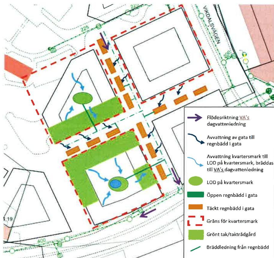
Figur 3. Ex på dagvattensystemets principuppbyggnad i Nacka Stad.
