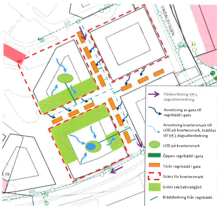
Figur 3. Ex på dagvattensystemets principuppbyggnad i Nacka Stad.
