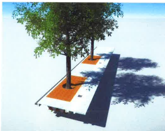
Figur 8. Täckt regnbädd i gata. Dagvatten från GC-bana leds in via luftningsbrunn med sandfång och perforerad sida till luftigt bärlager (t v i övre bilden) ner i skelettjorden som anläggs intill regnbädden. Dagvatten från väg leds via inloppsbrunn med sandfång (gul) till nedsänkt regnbädd som är täckt med markgaller eller plåt. Inloppsroret mynnar några centimeter över växtbädd. Överskottsvatten avleds via dränering och bräddbrunn.
