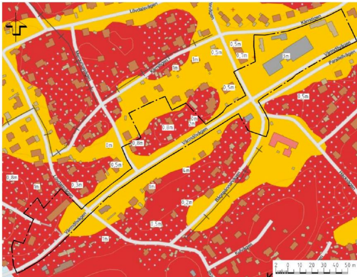
Figur 39. Jordarts- och jorddjupskarta. Gul yta är glacial lera, röd yta är berg, blå prickar är osammanhängande eller tunt ytlager av morän. Källa: SGU, hämtad 2019-12-11.
