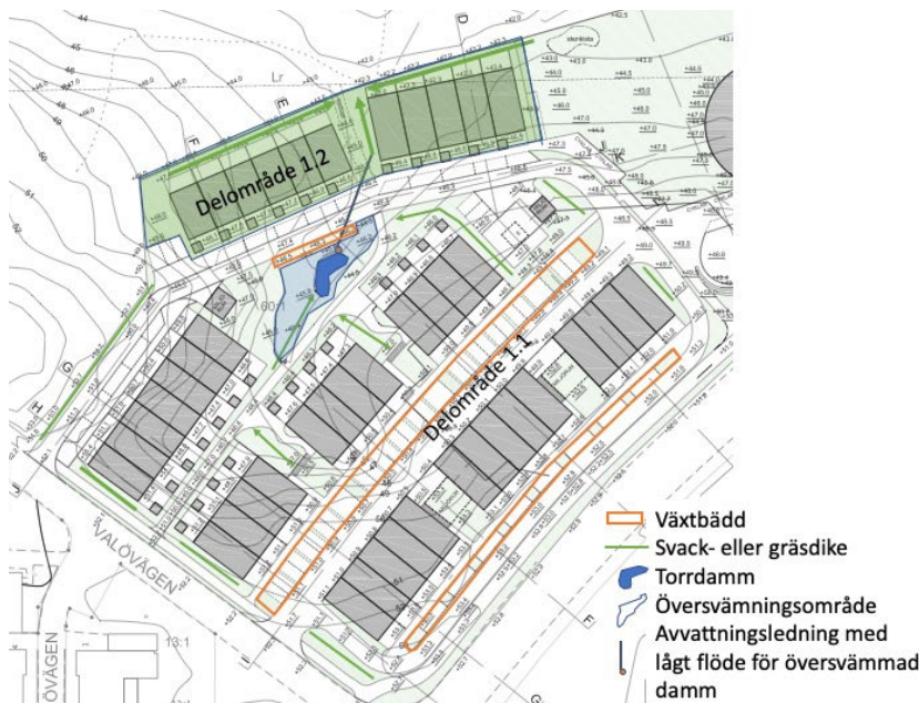
Figur 17 - Västra delen av området med dagvattenlösningar. En så kallad torrdamm kan anläggas i grönytan mellan husen. Oftast kommer det vara en torr gräsyta men när det regnar kan den fyllas till en viss nivå. Den kommer också att tjäna som utjämningsdamm vid höga flöden pga skyfall.
