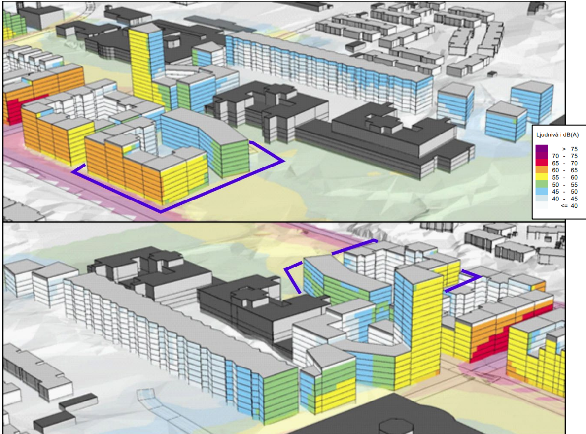
Ekvivalent ljudnivå vid fasad från vägtrafik Två vyer. Aktuelltt kvarter är markerad med blå linje.
