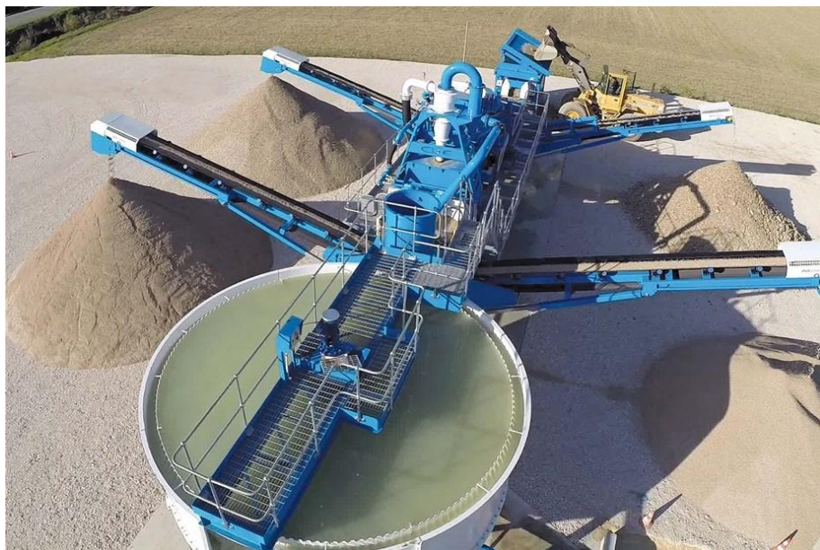
Figur 4-8 En våtsikt som lastas med material och olika fraktionerna längs som sorterats ut
