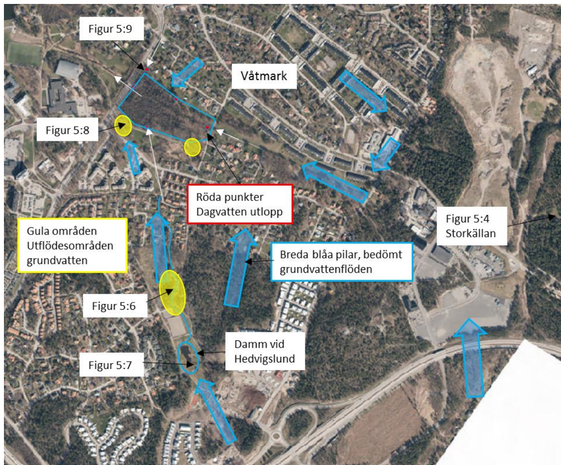
Figur 5:5. Grundvattenflöden och utflödesområden i tillrinningsområdet till Älta våtmark, bedömda enligt SGU:s grundvattenkartor och fältbesiktning. Hänvisning till var olika foton tagits.
