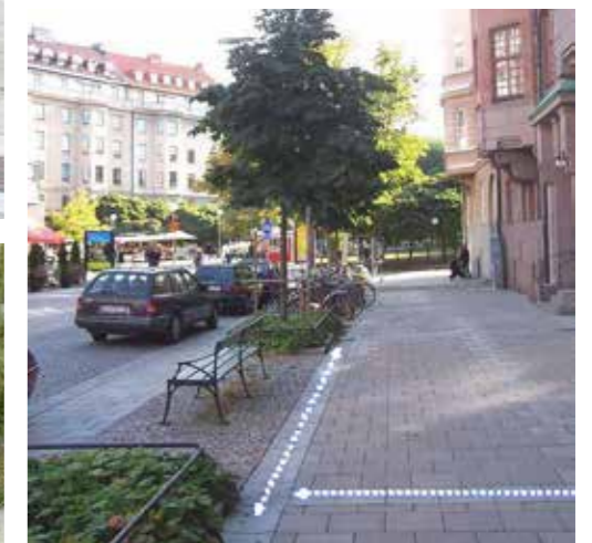
Angöringsgatorna är gemensamma för befintliga och nya fastigheter. Här ges plats för gående, cyklar, parkerade bilar, träd och genomfart till garagen. Det ges också plats för växtlighet och belysning. Härdgjorda ytor avvattnas till växtbäddar enligt principbild.
