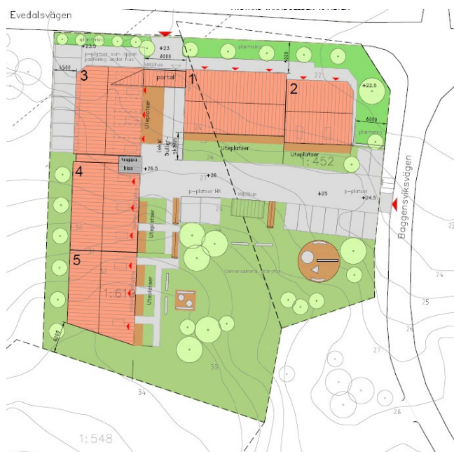
Illustrationsplan exempelutformning, byggrättens placering på fastigheterna Backeböl 1:452 och Backeböl 1:619 med volymer som anpassas till terrängen (NOOA, 2018).
