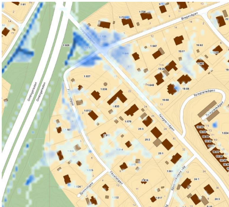
Kartillustrationen visar beräknat översvämningsdjup vid 100-årsregn (räknat med en klimatfaktor på 1,2). Källa: Översiktlig skyfallsanalys för Nacka kommun.
