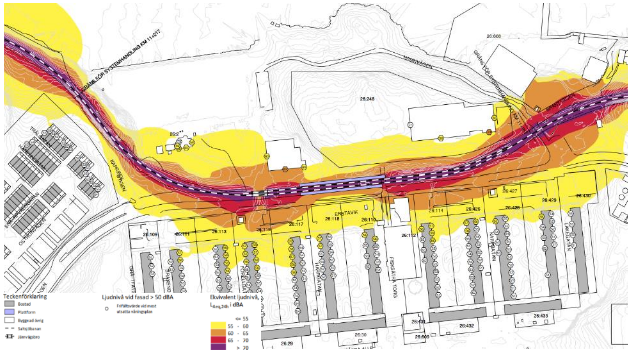
Nytt stationsläge, trafikflöde 2030. Ekvivalent ljudnivå från spårtrafik 1,5 meter över mark och vid fasad. Se illustrationen i sin helhet i ritning A03 Bullerutredning – Järnvägsplan, Fisksätra station Nacka, Akustikkonsulten, 2020-01-27.
