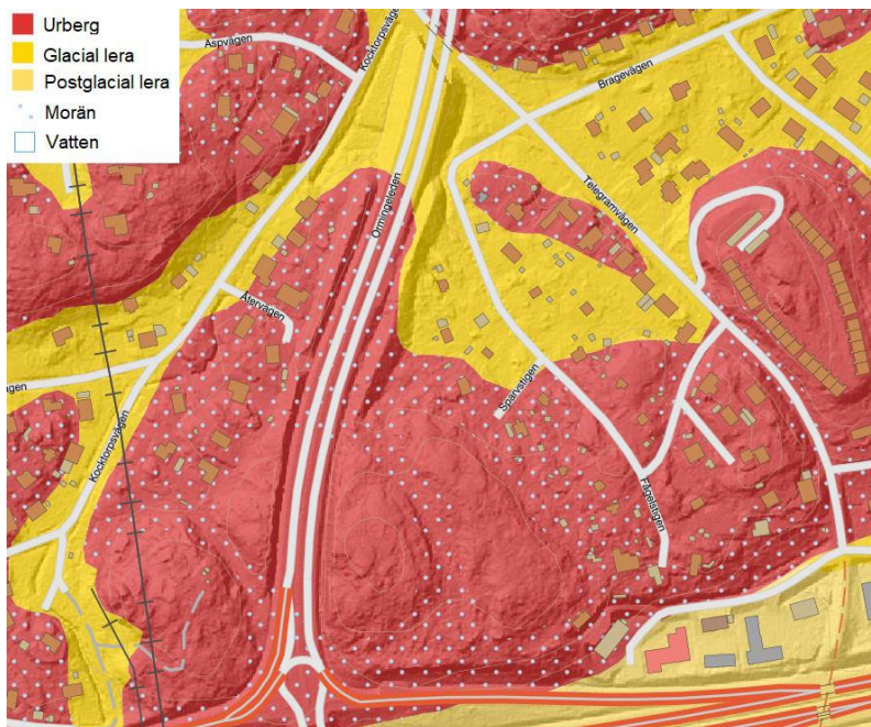
Geoteknisk jordartskarta som visar att marken inom planområdet består av urberg under ett tunt eller osammanhängande lager av morän, med inslag av lera (Bild: SGU).
