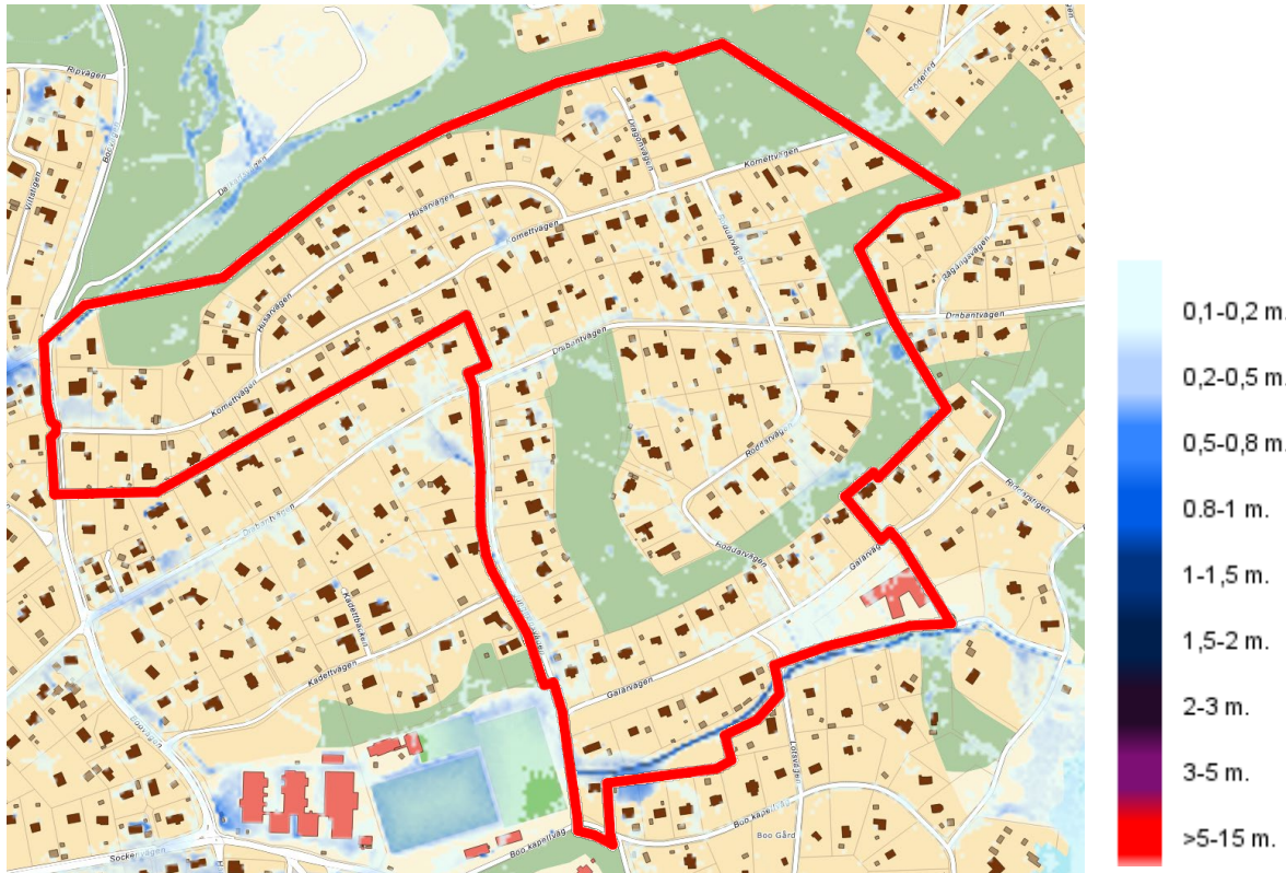
Översiktlig skyfallsanalys för Nacka kommun, 2015-05-07. Planområdet markerat med röd linje. Framtida djup vid 100-års regn med klimatfaktor. Bild: Nacka kommun.
