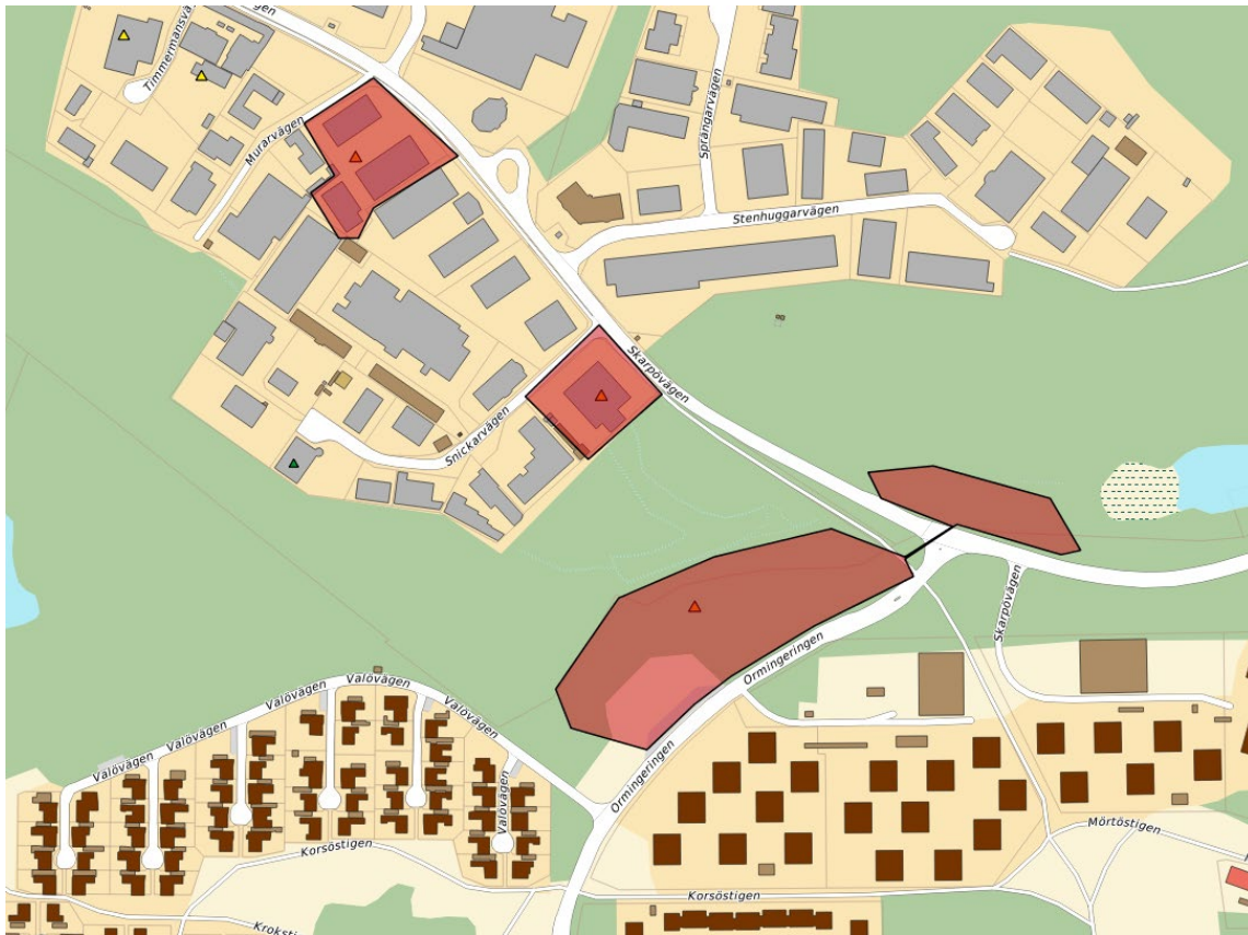
Figur 17 - Närområdet med planområdet i korsningen Ormingeringen-Valövägen, före detta deponiområde och verksamheter i Kummelbergets verksamhetsområde där kemtvätten är den södra röda fyrkanten som ligger vid Skarpövägen. Myrsjöns västra vik ansas till höger i bild. Bilden visar även diken som leder vatten mellan planområdet och verksamhetsområdet mot Myrsjön.
