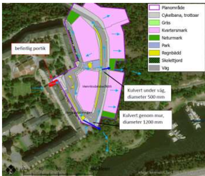
Figur 28. Planerad skyfallshantering. Ljusblå pilar visar flödesvägar vid extrema regn. En stor del av vattnet som faller över planområdet och den intilliggande Henriksdalsringen föreslås ledas in i två kulvertar (mörkblå pilar) som leder vattnet mot Svindersviken.
