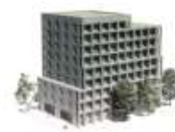
Princip för utformning. Balkonger utformas indragna i volymen.
