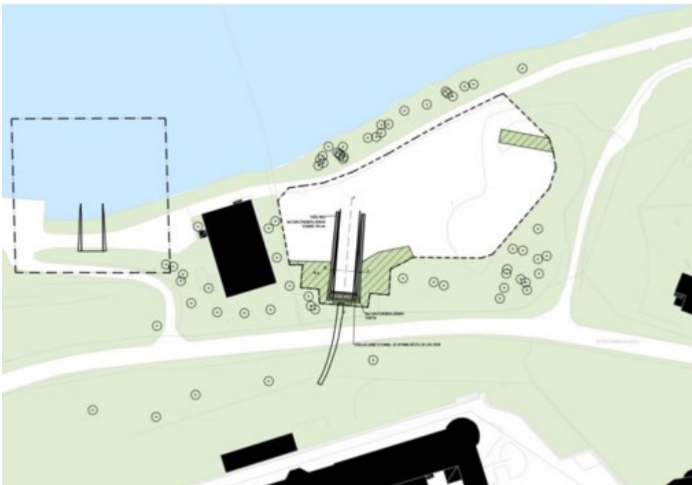
Utformning av påslaget och utloppet i plan, bilden är inte skalendig. Illustration från Stockholm Vatten och Avfall AB.
