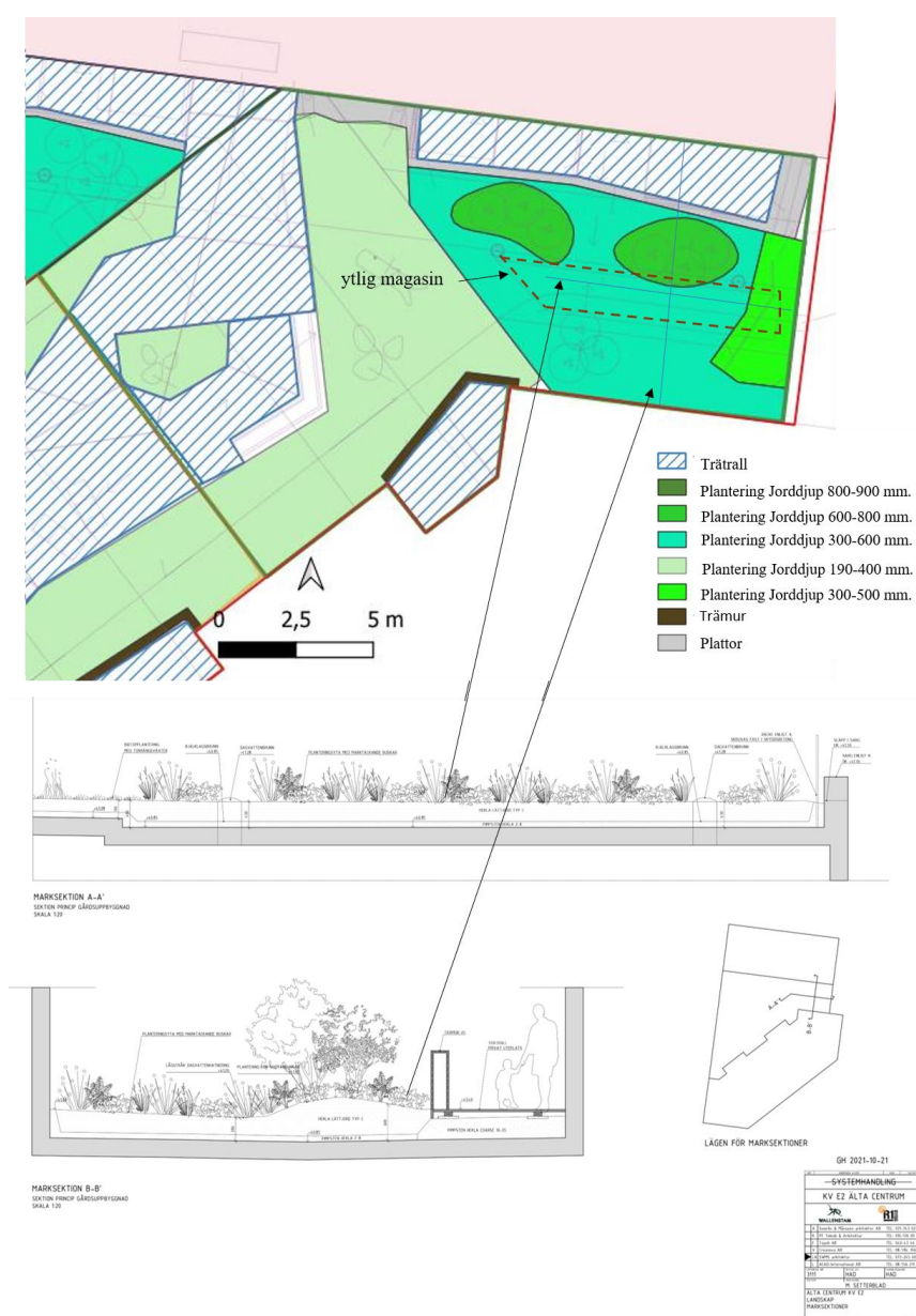
Figur 7. Sektion princip gårdsupbyggnad och planerad plantering inom område B. Källa: (Wallenstam AB, 2021a)
