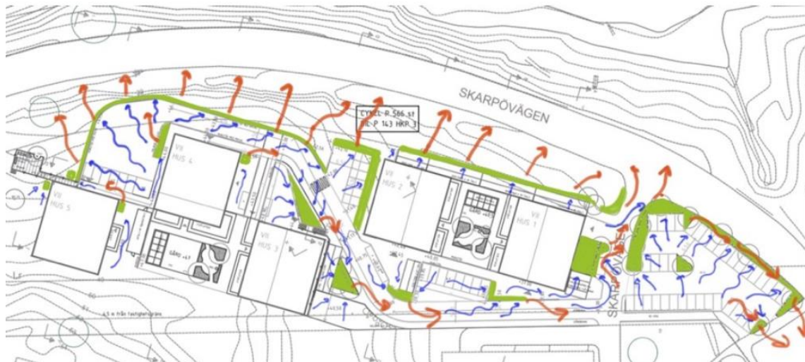
Figur 18. Röda pilar representerar avrinningsvägar vid kraftiga skyfall när växtbäddarnas kapacitet har överskridits. Kommande detaljprojektering kommer behöva anpassas till dessa principer samt riktlinjerna från Svenskt vatten om marklutningar vid byggnader.
