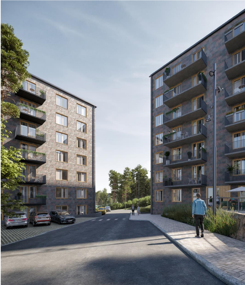
Figur 6 - Perspektiv över möjlig utformning av bebyggelsen sett från den föreslagna lokalgatan. Vy mot sydöst. Takfotshöjd, maximal takvinkel, fönstersättning i vertikala band, fasadmaterial och accentfärger styrs av plankartan. (Arkitema, 2021)
