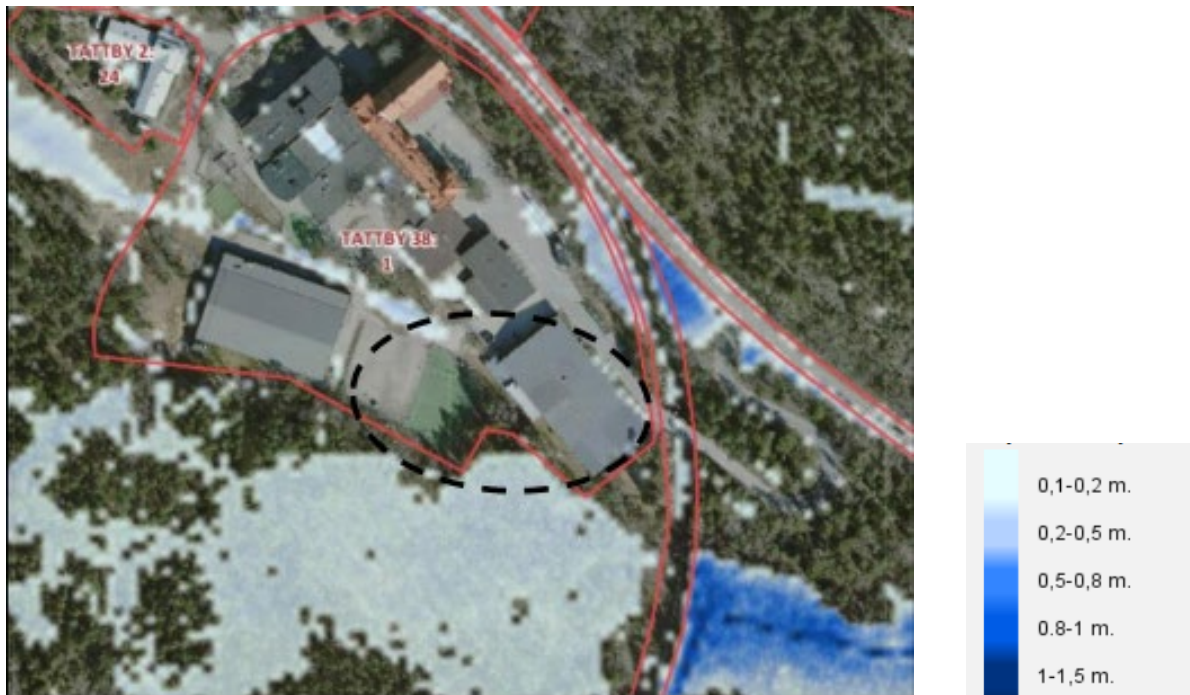
Figur 10. Utdrag från Nacka kommuns skyfallsanalys (klimatfaktor 1,2). Planområdets ungefärliga lokalisering är markerad med en svartstreckad ellips.
