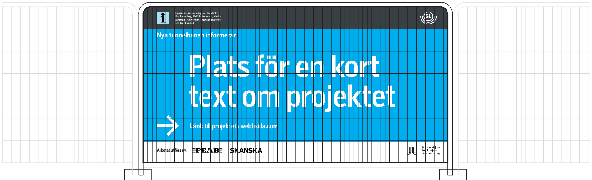
Elevation byggstängsel, skala 1:20 i A4
