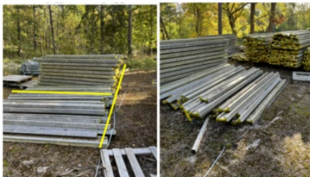
Delar av byggställning uppmättes till 2,9x2,8 meter, se gul markering.
