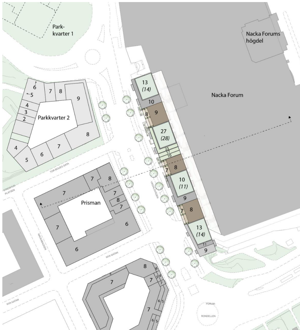
Figur 3: Situationsplan som visar antalet våningar på de olika volymerna inom Nya Nacka Forum samt på de två befintliga byggnaderna på västra sidan av Vikdalsvägen, och på föreslagen byggnad inom Parkkvarter 2. Siffran inom parentes avser takträdgården/takterrassen som har förhöjda fasadmurar vilket gör att de i stadsbilden upplevs som en våning. Den streckade linjen visar var sektionen i figur 4 är dragen. (Bild: Koncept part of AFRY/Nacka kommun)
