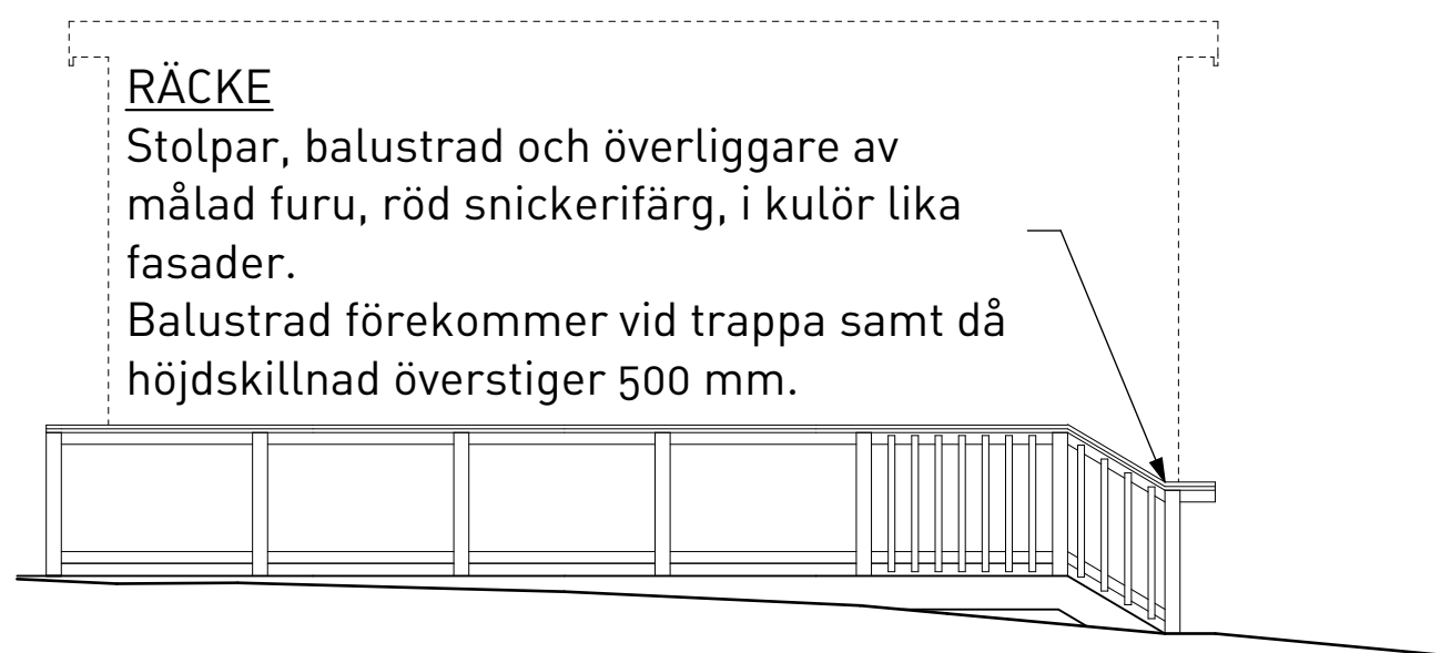
VY MOT SYDÖST Nytt räcke
