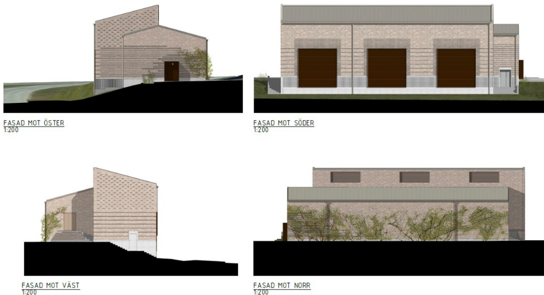
Figur 2: Fasadritning som redovisar byggnadens föreslagna material, som är tegel, vilket ska varieras genom olika murningstekniker. (Urban Design 2026). Bilden visar en möjlig utformning som slutligen avgörs vid bygglov.
