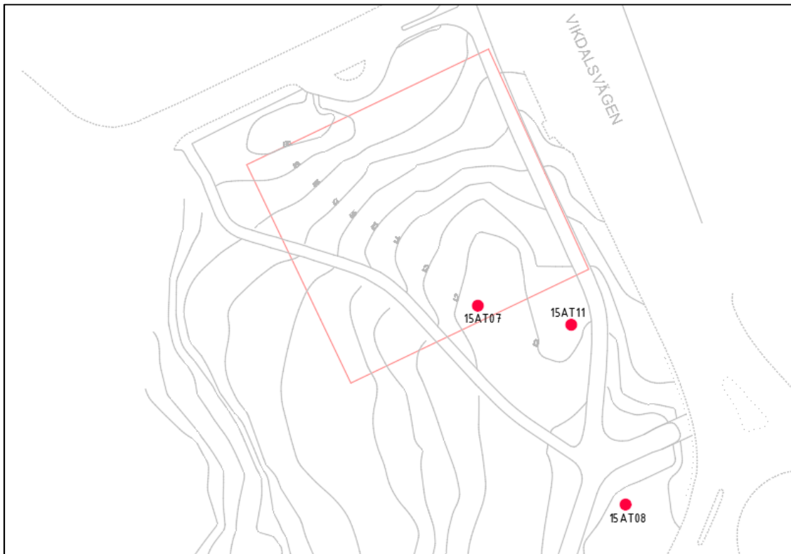
Figur 2-4. Grundvattenrörens placering i förhållande till utredningsområdesgränsen, som är utmärkt med en röd polygon.
