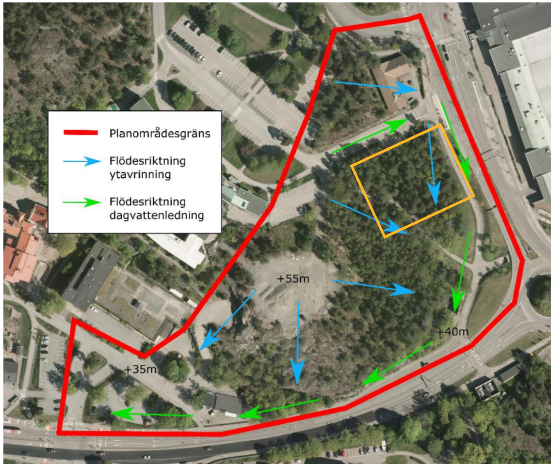
Figur 2-5. Avrinning för hela detaljplaneområdet för Nya gatan, bild från Swecos rapport ”Dagvattenutredning för detaljplan Nya gatan, Nacka kommun”, 2016-05-26. Utredningsområdet är inlagt i bilden, markerat med en orange rektangel.
