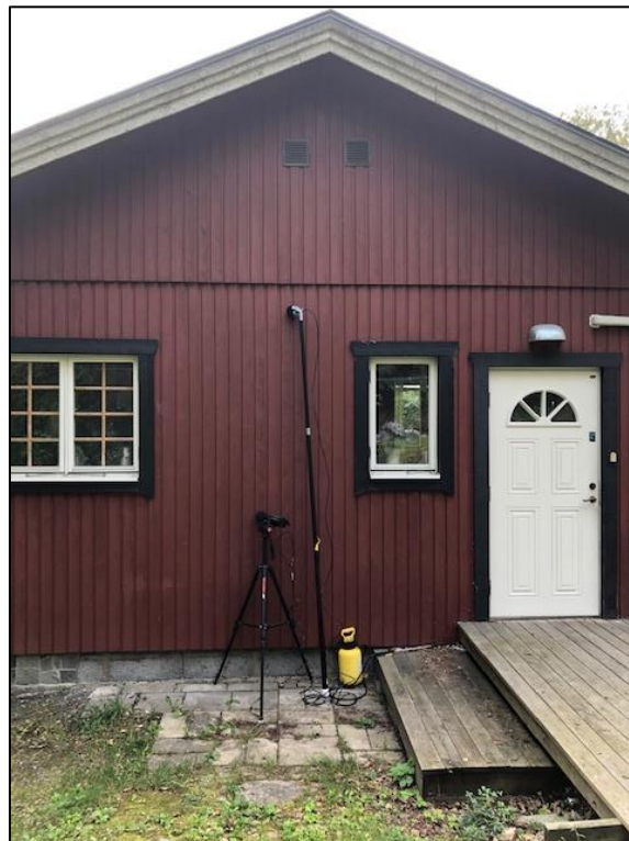
Figur 2. Placering av mätutrustning mot fasad på befintlig byggnad på Hjortängsvägen 35. En på 1,5 m höjd och en på 3 m höjd. En motsvarande mätning utfördes på befintlig byggnad på Hjortängsvägen 24.
