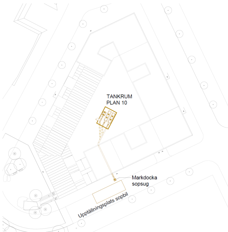
Figur 3. Planerad placering av sugbilens tömningsplats (dockningsstation, markdocka)
