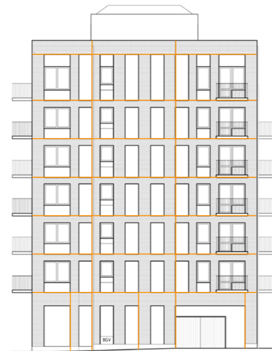
Princip - elementskarvar integreras i fasadens rutsystem.
