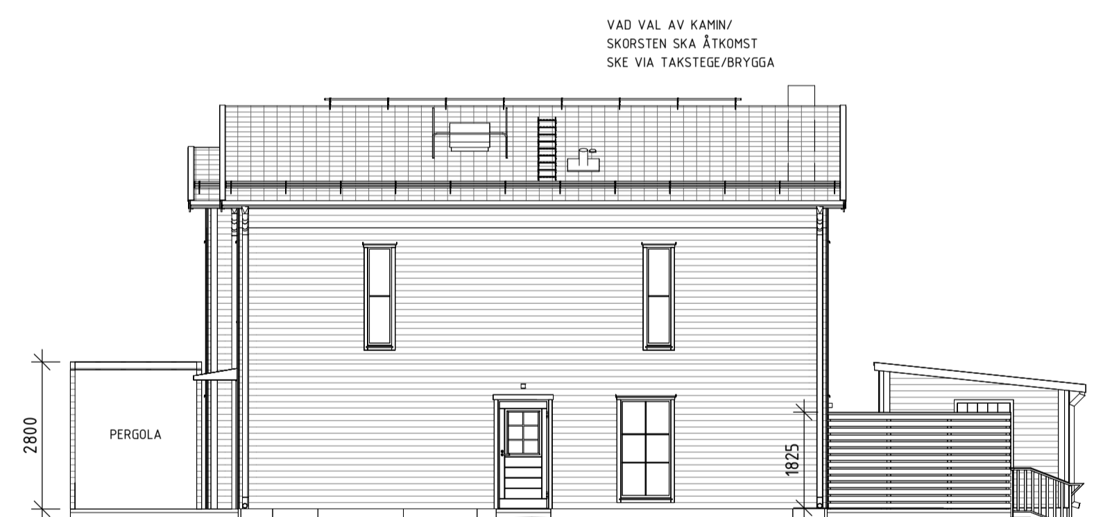
FASAD, HUS C2 805 - GAVELSIDA HÖGER
