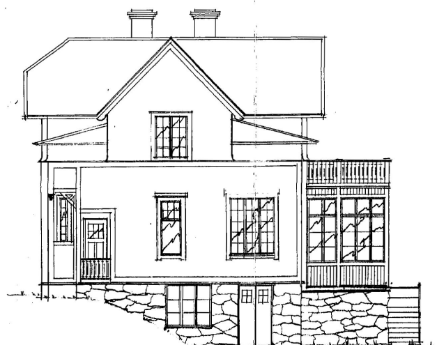
Förslag till ombyggnad, 1994. Glasveranda har ersatt burspråk (befintlig altan saknas på ritning).
