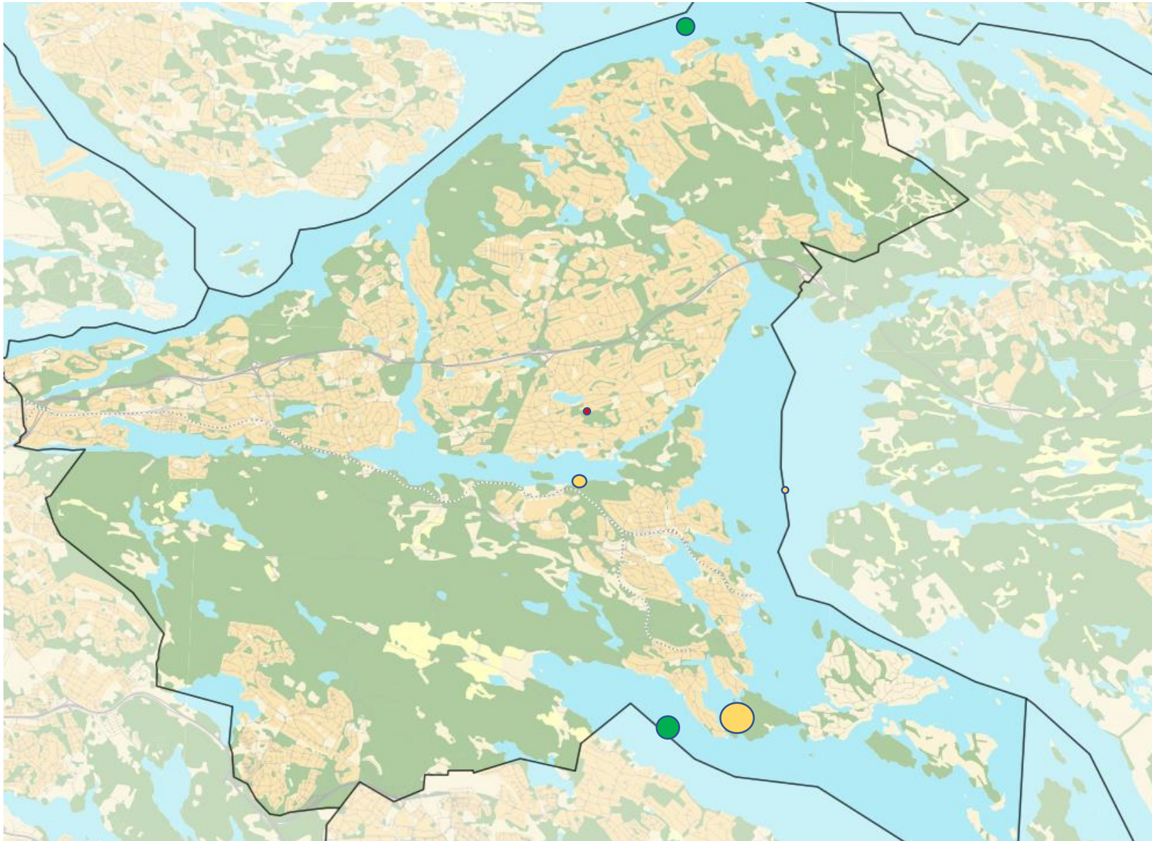
Karta med bräddpunkter utplacerade. Färg kopplar till recipientens statusklassning där grön motsvarar God ekologisk status, gul motsvarar Måttlig ekologisk status och röd motsvarar Dålig ekologisk status. Storleken på prickarna illustrerar storleken på utsläppen.
