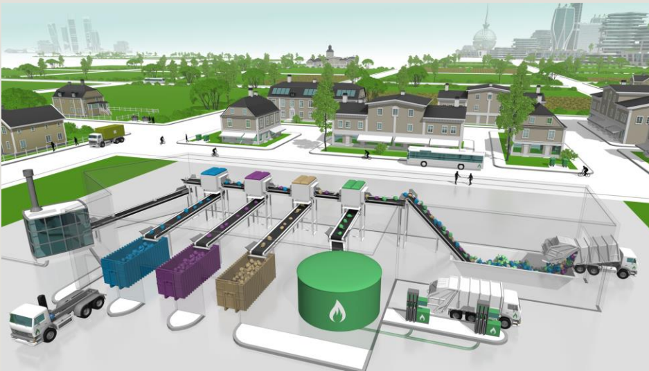
Figur 4 Illustration över optisk sortering (Bildkälla: Envac.)
