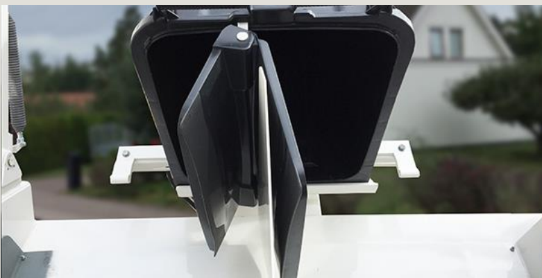
Figur 3. Tvåfackskärll töms i sidlastande fordon utrustad med "hajfena", foto San Sac.
